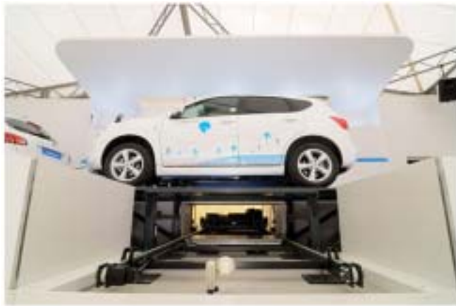
<그림 5-14> 배터리교환 방식 전기자동차 충전설비
